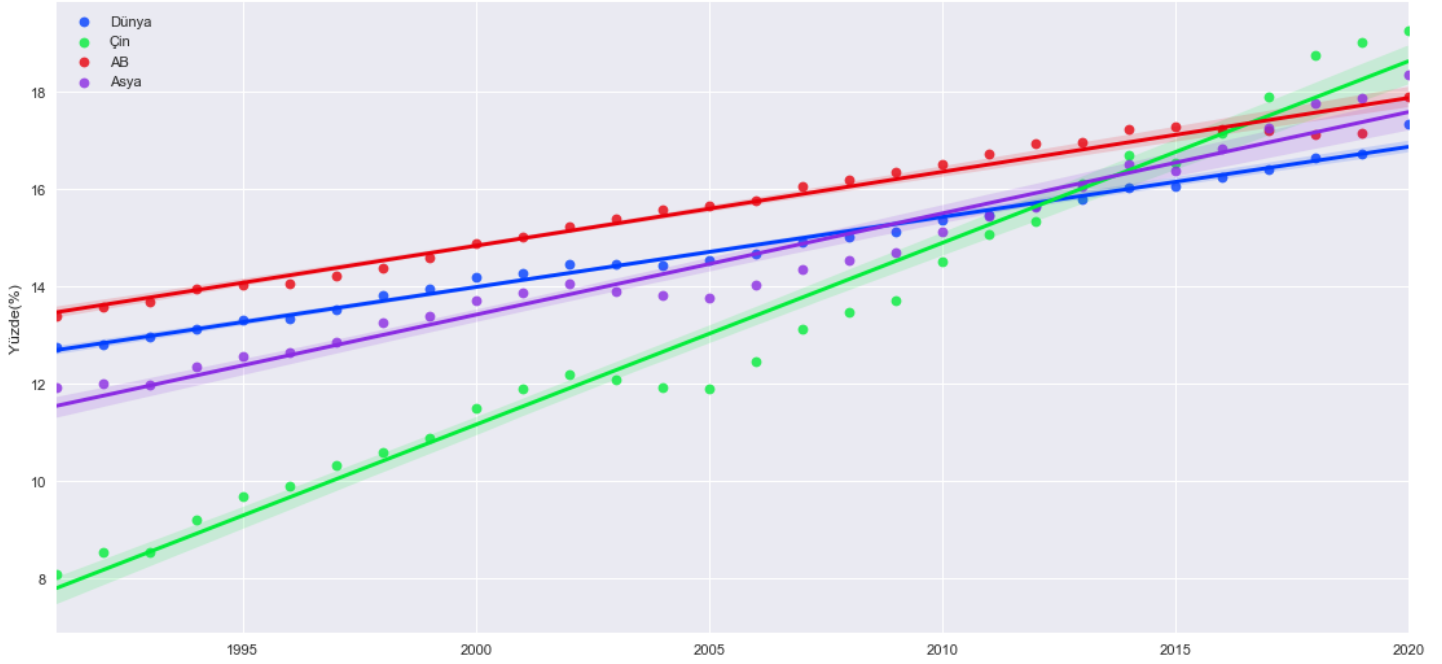
Dünyada son 30 yılda Çin hariç ve Çin dahil dünyada elektriğin birincil enerjiye oranı
