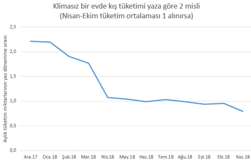
Şekil – Klimasız bir evde Nisan – Ekim döneminde 1 birim olan tüketim, kışın 2.2 misline kadar çıkmaktadır
